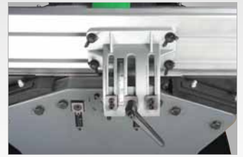
Der Aluminium-Abrichtanschlag ist um 45° neigbar. Die eingestellte Neigung ist bequem an einer Skala ablesbar. (Abbildung zeigt ADH 250)
