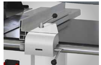
Großer Aluminium-Parallelanschlag auf Rundstangenführung mit Feineinstellung
