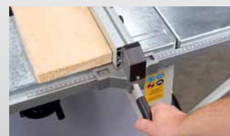
Der Parallelanschlag mit Exzenter-Schnellspannung kann per Skala präzise und leicht eingestellt werden.
