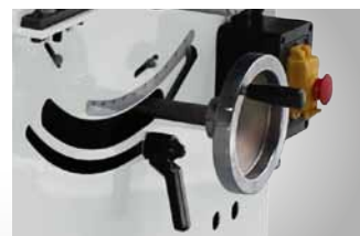
Sägeblattschwenkung von 0° bis 45°, bequem verstellbar über Drehknopf und Skala per Zahnstangenmechanismus
