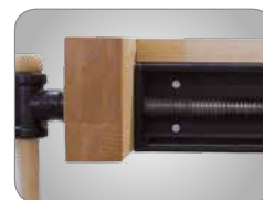
Besonders massive Linearführung an der Hinterzange
