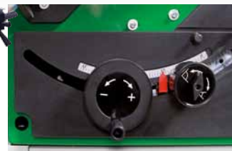
Sägeblattschwenkung von 0° bis 45°, bequem verstellbar über Drehknopf und Skala per Zahnstangenmechanismus
