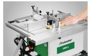
Tischfräse zum Fügen und Profilieren von Leisten und Brettern
