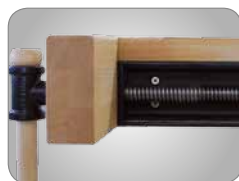
Massive Linearführung an der Hinterzange
