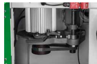
Schnelles und einfaches Wechseln der Drehzahl mittels Vielkeilriemen
