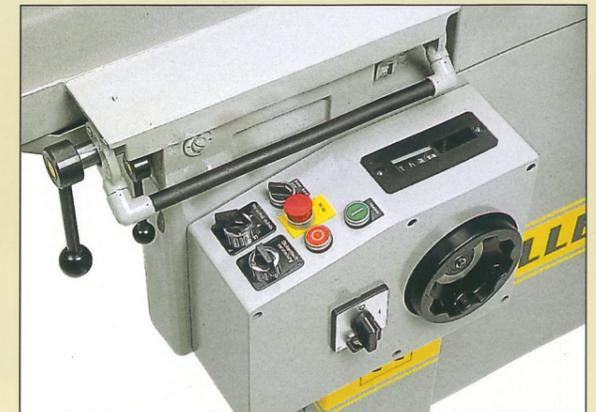
Die Abrichttische werden am Bügelgriff angehoben und abgeschwenkt. In beiden Endlagen sind sie automatisch verriegelt. Mit dem Schnellverstellhebel wird der Aufgabetisch auf die Spanstärke eingestellt.
