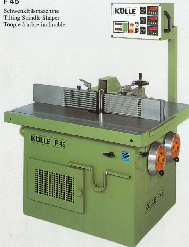
Fräsanschlag mit 3 digitalen Maßanzeigern in der Grundausstattung. Stabile und präzise Bauweise für beste Fräsarbeit. Die Bedienung benutzerfreundlich, mit schwenkbarem Bedienpanel. Auch mit langem Maschinentisch lieferbar. **Die Schwenkfräse F 45 verdient Ihr Vertrauen.**
