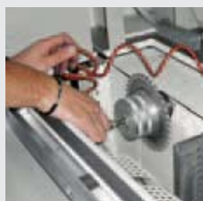
Pneumatic flanges locking/unlocking for main and scoring blade Pneumatische Verriegelung der Haupt- und Vorritzsägeblattflansche
