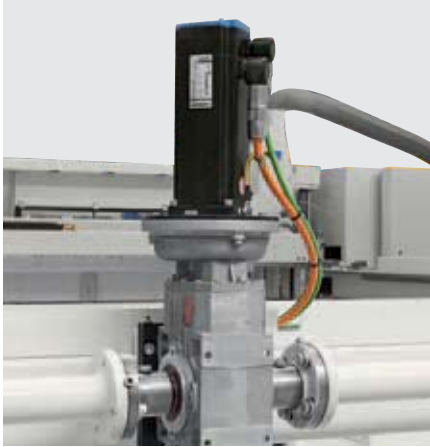
Heavy duty pusher and pusher servo positioning for HD versions Schieber und Schieberantrieb HD-Versionen
