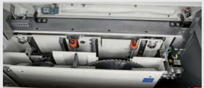
Optional saw carriage over 4 THK ways. Standard for HD Serie Optionssägewagen mit 4 THK-Führungen. Serienmäßig für HD Serie
