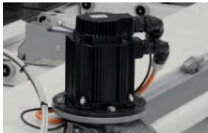
DC servo motor. Antrieb mit Gleichstrom.
