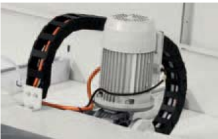
AC servo motor. Antrieb mit Wechselstrom.
