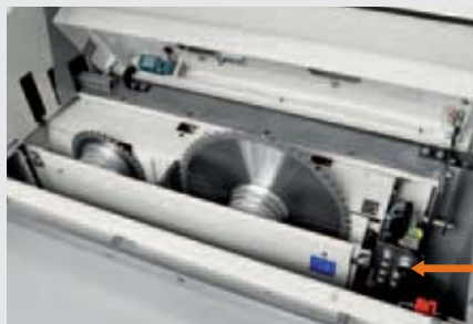
Pneumatic flanges locking/unlocking for main and scoring blade Pneumatische Verriegelung der Haupt- und Vorritzsägeblattflansche
