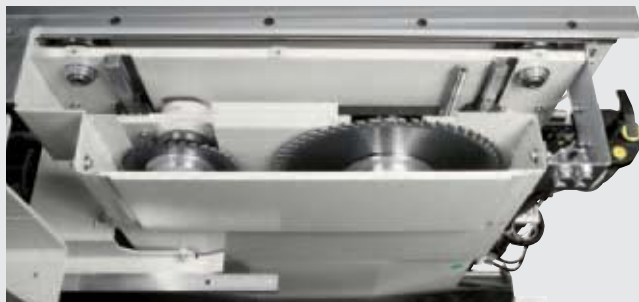
Standard saw carriage over 2 THK ways Standardsägewagen mit 2 THK-Führungen
